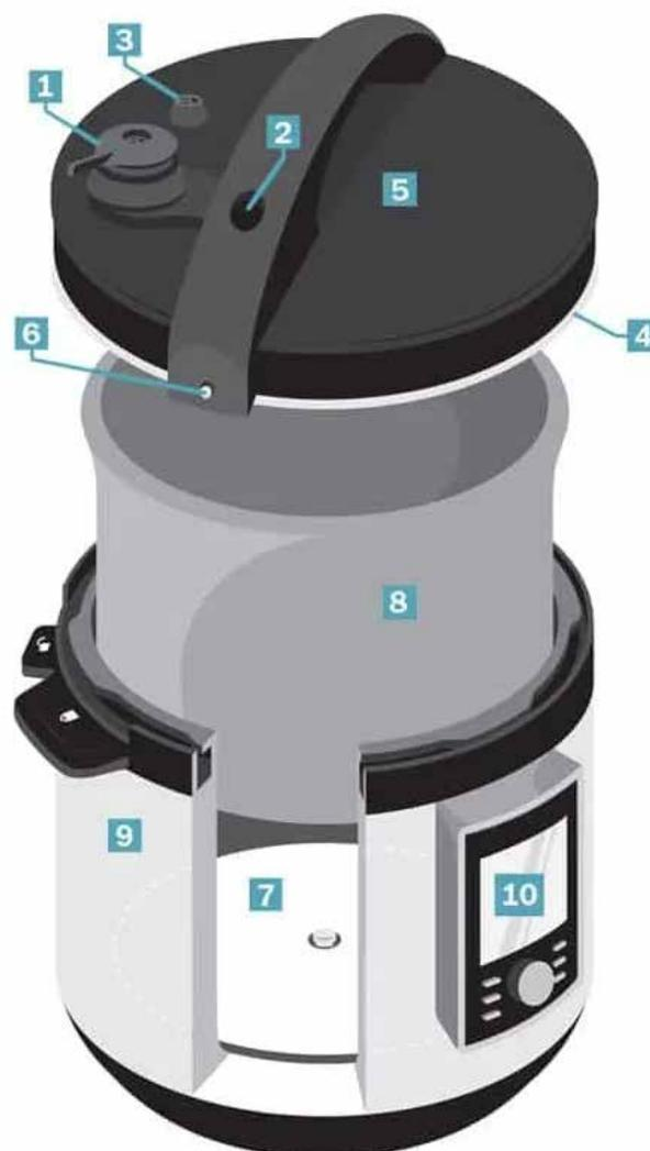
Die Deckelpositionsanzeige wird während des Druckkochens aktiviert, um zu informieren, dass der Deckel korrekt verschlossen ist. Es ist nicht möglich den Deckel zu öffnen, wenn er unter Hochdruck verriegelt ist.
